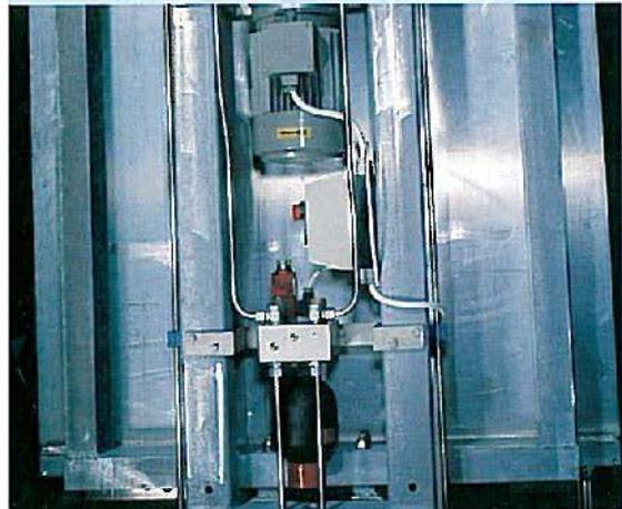
Гидравлическая станция типа Power Pack, смонтированная на горизонтальном плиточном скороморозильном аппарате
